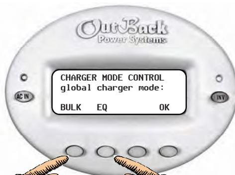
**Примечание:** Прежде чем запускать цикл EQ, запустите генератор или проверьте подключение к сети. Светодиод состояния AC IN на FX должен непрерывно светиться желтым цветом.
