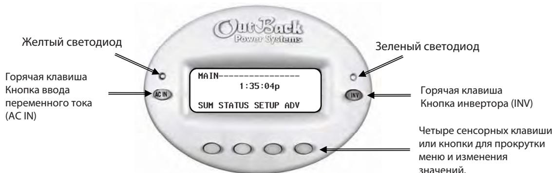
Желтый светодиод над горячей клавишей AC IN работает в одном из трех режимов:
