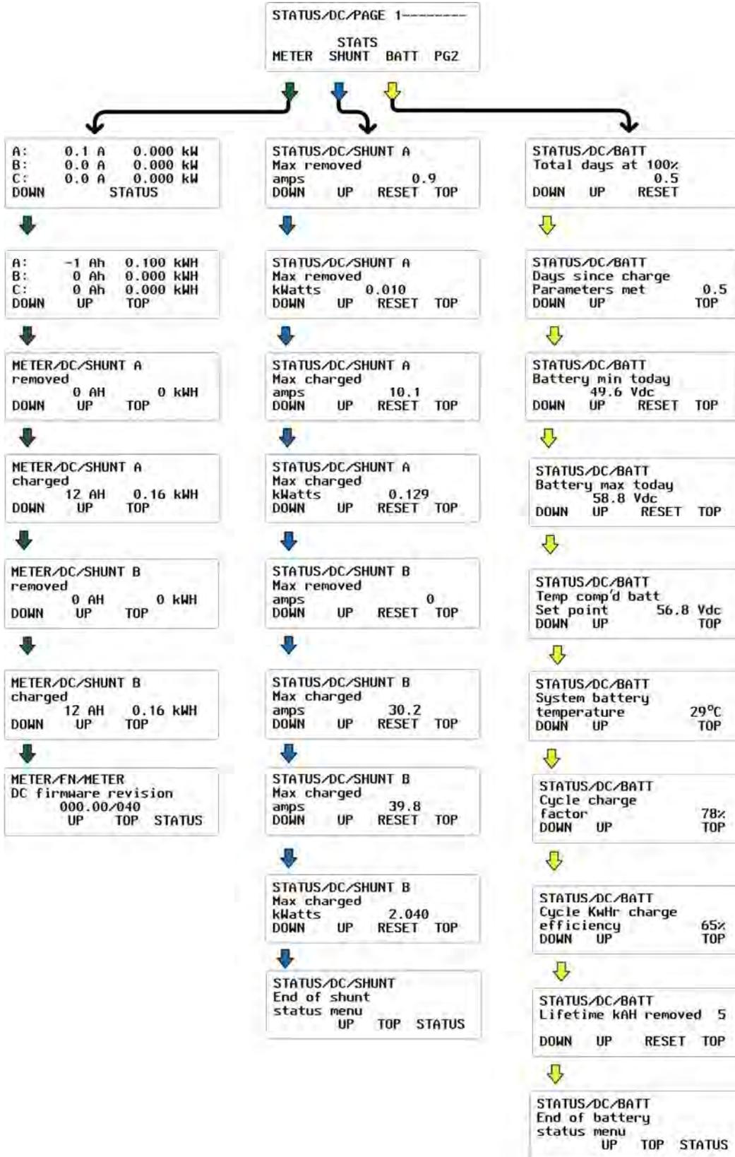
Рис. 85 Меню состояния FLEXnet DC (FNDC)
